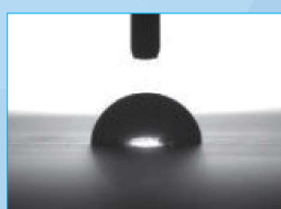
A-068 ブランク 接触角:84.2度 A-068 Without treatment Contact angle: 84.2 degrees
